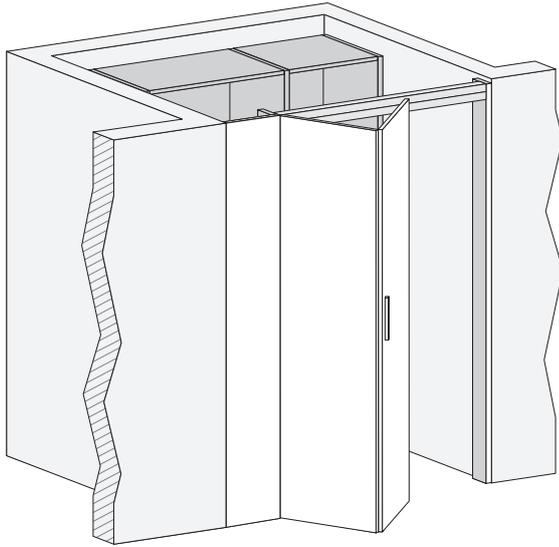
**Esempio di utilizzo struttura di chiusura OBLIQUA a 45°**
